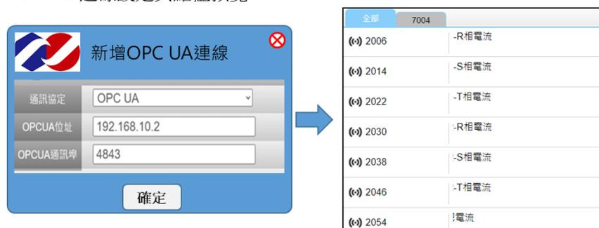
第二步設定顯示圖樣並與 OPC UA 點位綁定：SCADA 系統主要的顯示內容為數值、文字、布林、時間與圖片，所以透過與實際場域考察與 SI 業者經驗，將現有機器常用的 UI，整理成常用的圖像物件，使用者可只需擊物件就可以動態產生一個預設圖形至畫面上，當系統接收到 OPC UA 的資料時，因為該資料已經經過標準化，所以可知道所代表之意義。例如，所收編號 x 的點位數值是 50，屬性被定義為某管線的壓力值，而在 SCADA 系統上想呈現的是對於該數據長時間的變化監視，此時可拖拉是先建置的折線圖套件拖曳至畫布上，並連結點位 x，即可將此數值有意義的呈現在系統上，如圖 6 所示。
